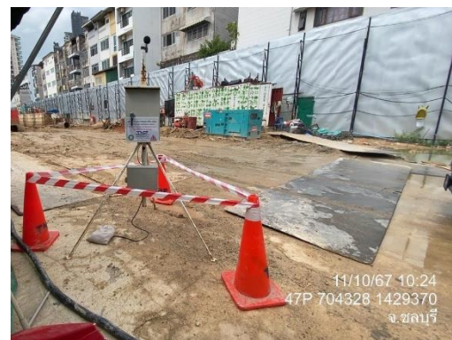
รูปที่ 12 ติดตั้งเครื่องตรวจวัดคุณภาพอากาศ เสียง และความสั่นสะเทือน
