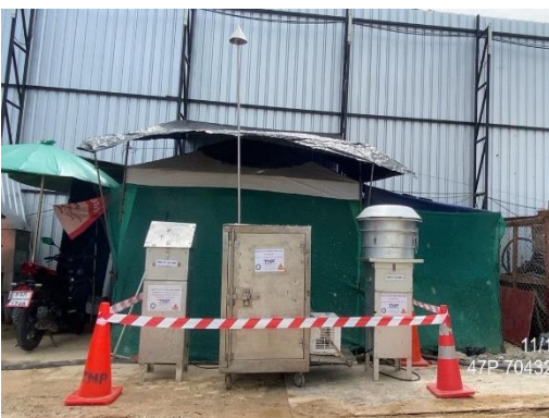
รูปที่ 12 ติดตั้งเครื่องตรวจวัดคุณภาพอากาศ เสียง และความสั่นสะเทือน
